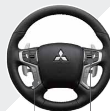
שליטה על השמע והדיבורית שליטה על בקרת שיוט ומגביל מהירות
